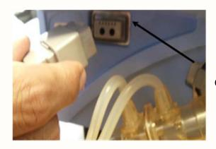
Colocación del sensor de flujo
