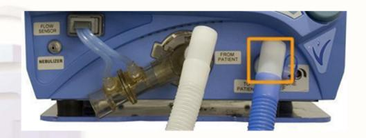
8. Se puede utilizar un nebulizador en línea con el ventilador Vela. Conecte la línea de entrega de gas del nebulizador en el conector para esta función.
