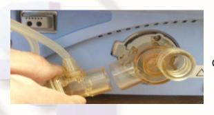
Conexión del sensor al cuerpo de exhalación.
